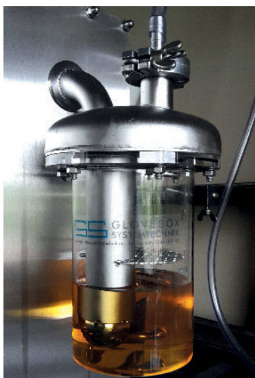
Abb. 2. Sicherheits- und Komfortventil (von GS Glovebox-Systemtechnik).
