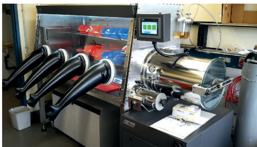
Abb. 1. Vierarmige Glovebox an der Universität Regensburg mit kleiner und großer Transferkammer sowie Sicherheits- und Komfortventil (oben rechts).
